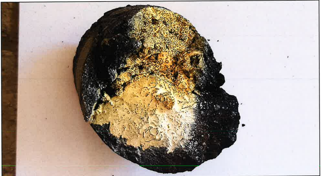
Abb. 2: PAK Schnelltest an Probe RKS 25/1 (0,0-0,07) mit deutlich gelber Verfärbung
